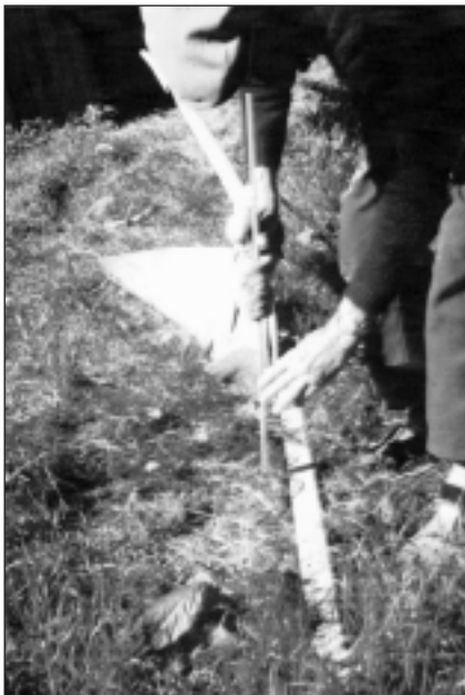
Figure 1 — Le charron, après avoir fait passer une réglette par la mortaise du régulateur et, après avoir disposé une règle le long de la semelle, fait la démonstration que cette charrue, un troer , est trop « hardie » (Trémaïdic-Ijella en Plouzané, 1974).
