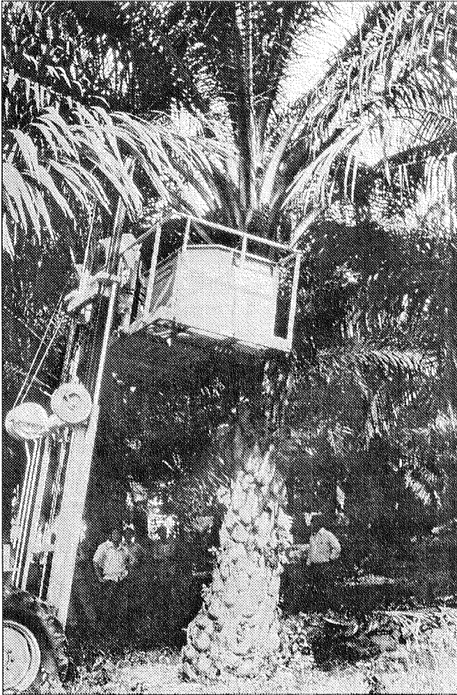
La nacelle Sambron (palm-harvester) pour la récolte des régimes du palmier en Côte d'Ivoire.
