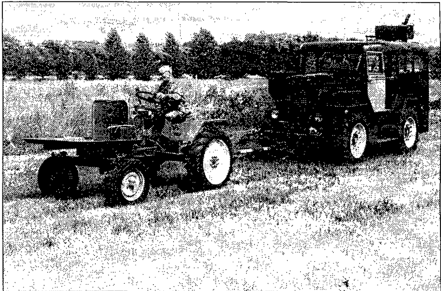
Essais à Antony du tracteur Bouyer avec le camion-frein du CNEEMA.
