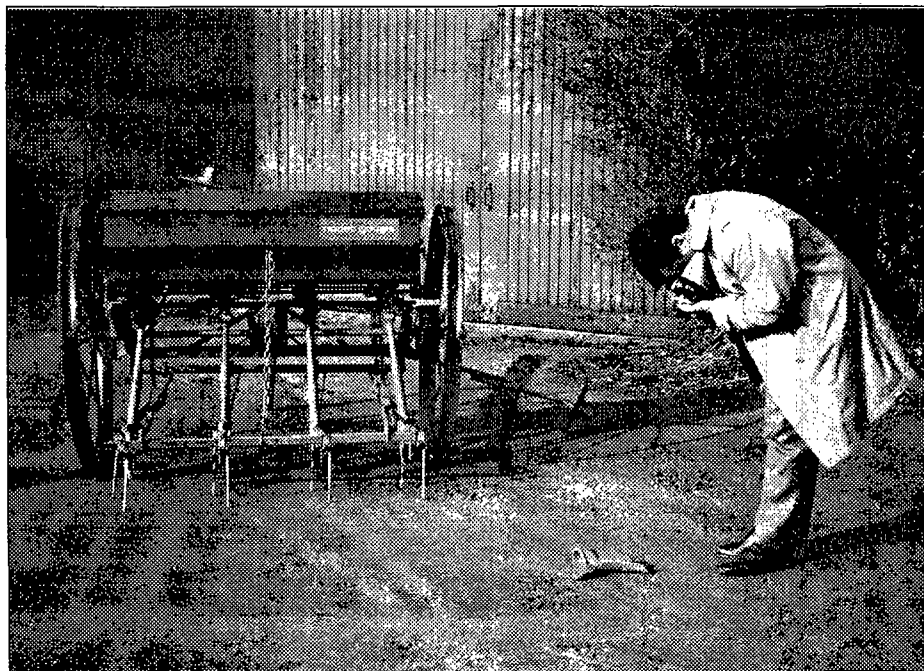
Prototypé de semoir à 4 rangs, à traction animale (1971).
