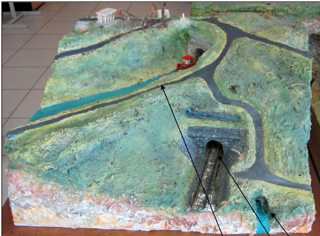
Maquette montrant comment les trois tunnels (Canal du Midi, voie ferrée et eaux d'évacuation du périmètre) passent sous le Malpas
