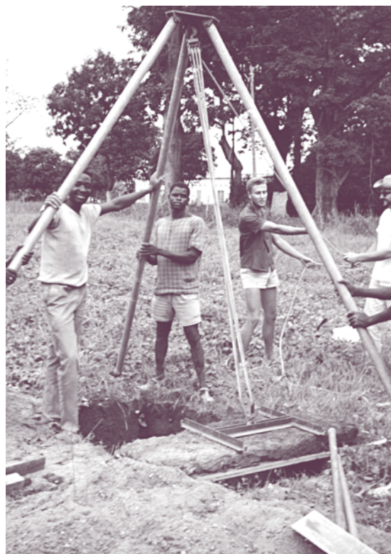
Prélèvement de "planche de fakir", une des méthodes d'étude de l'enracinement des graminées fourragères tropicales (août 1965). En haut : mise en place de la planche dans une fosse creusée à cet effet. En bas : extraction de la planche. La couche de terre sera ensuite éliminée par aspersion d'eau, les racines maintenues en place par les pointes de la "planche de fakir" (une pointe tous les 10 cm) apparaîtront à leur place approximative dans le sol.
