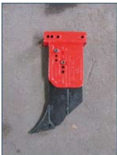
Planche 59. Un chisel de type corps rayonneur pour une faible perturbation du sol (T. Friedrich).
