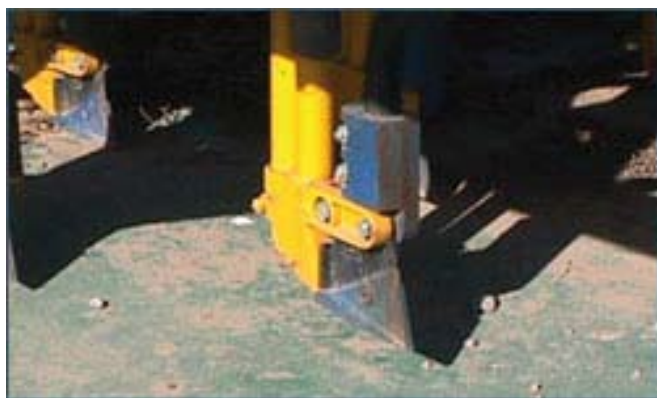
Planche 60. Ouvre sillon en forme de T retourné (T. Friedrich).
