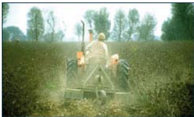
Planche 25. Un gyrobroyeur utilisé pour broyer les tiges de cotonniers. (T. Friedrich).
