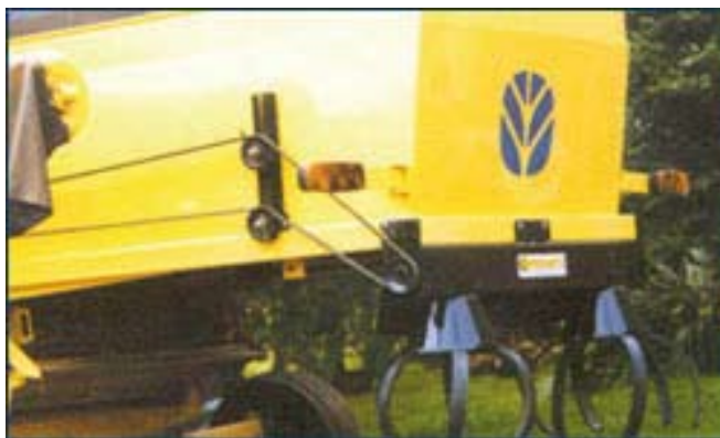
Planche 27. Épandeur de pailles attelé à une moissonneuse - batteuse (MAX - Irmãos Thonnigs Ltda.).
